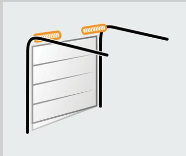
**SN-Beschlag:** Normal-Beschlag mit Torsionsfeder-Technik mit schräger unterer Lamelle (max. 300 mm Höhendifferenz)
