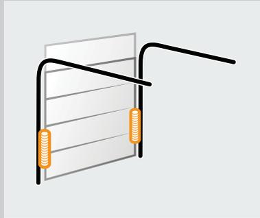
**BZ-Beschlag:** Zugfeder-Beschlag mit Zugfeder-Technik und flächenbündiger Blende
