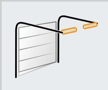
**SL-Beschlag:** Niedrigsturz-Beschlag mit Torsionsfeder-Technik mit schräger unterer Lamelle (max. 300 mm Höhendifferenz)
